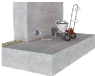
Injection selon le principe de comblement
