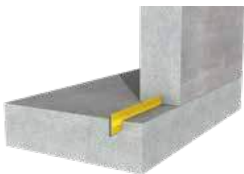
Bande de joint selon le principe de labyrinthe
